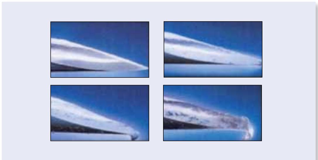
Figura 3.2 Deformazione della punta di un ago riutilizzato (Tratto da Torrance 2008).
